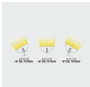
Fatta eccezione per i modelli Frio, le versioni per lampade a ioduri metallici con attacco Rx7s consentono l'orientamento libero del fascio luminoso mediante l'inclinazione del riflettore.
