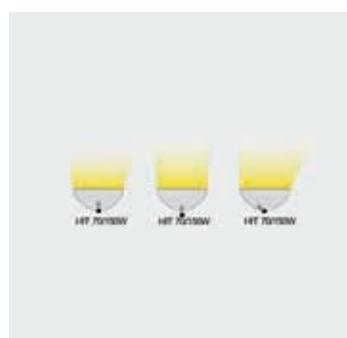
Le versioni per lampade a ioduri metallici con attacco G12, fatta eccezione per i modelli Frio, consentono invece di ottenere fasci simmetrici e asimmetrici ad ampiezza regolabile.
