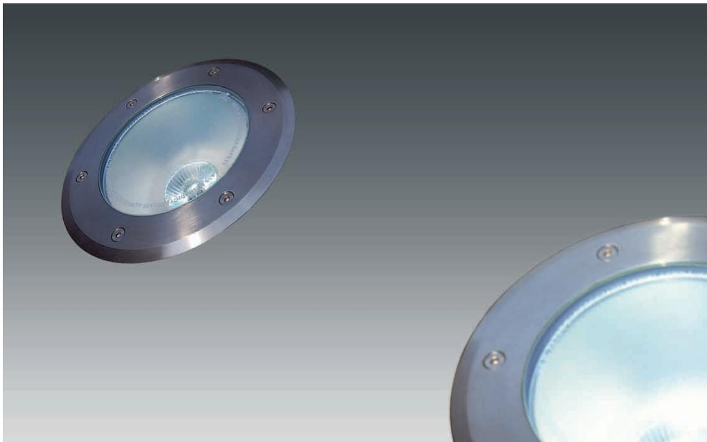
Era è un apparecchio per esterni da incasso a pavimento per uso sia pedonale che carrabile. È realizzato con struttura e anello di chiusura in acciaio inossidabile, vetro temperato infrangibile (spessore 10 mm) e guarnizione di chiusura in gomma al silicone. È indicato per l'illuminazione di giardini, viali d'ingresso, scale di piccole e medie dimensioni.
